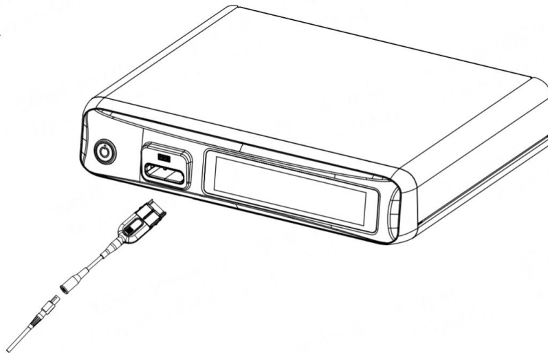
Figura 3-3 Diagrama esquemático de la conexión entre el endoscopio y el procesador de imágenes HUV -02
